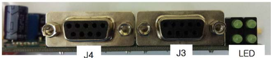
J4 : Modbus (D-sub 9Pin), J3 : BPS37 setup (D-sub 9Pin)
