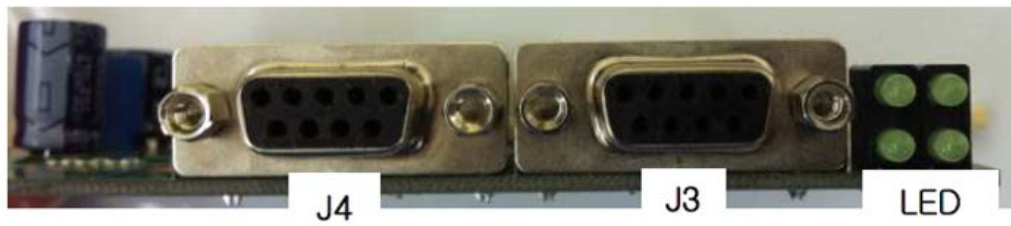
J4 : Modbus (D-sub 9Pin), J3 : BPS37 setup (D-sub 9Pin)
